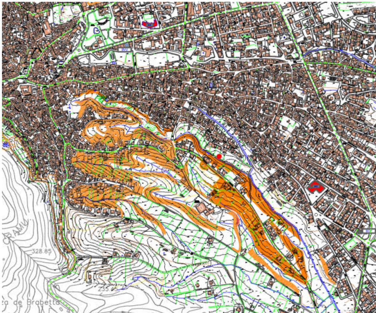
La prima area in ordine di importanza è quella relativa ai versanti della cora di sant'Antonio che, in particolare nel tratto tra via Tirso e via Po, erode la scarpata della sponda di destra idraulica mettendo a rischio le case a monte dello stesso versante con il passare del tempo.
